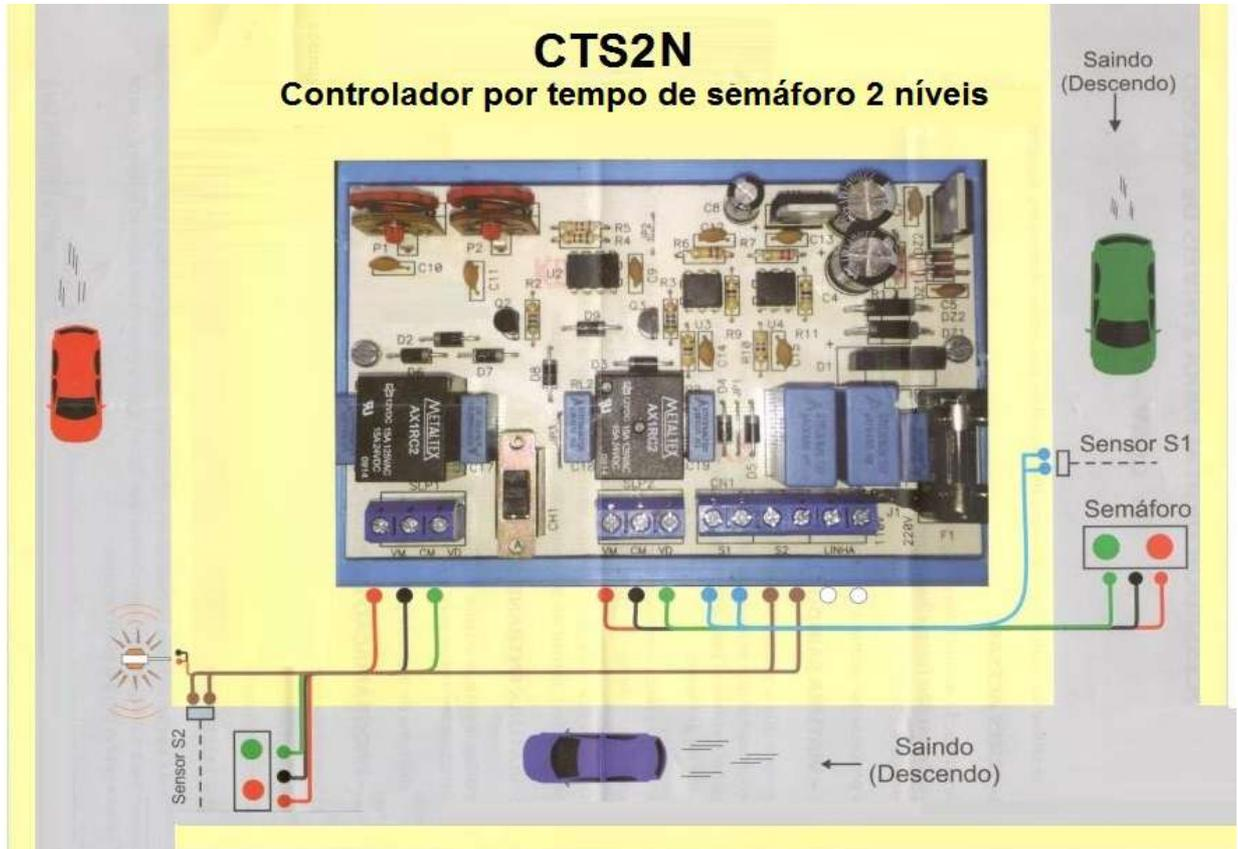
Exemplo de ligação para circulação de veículo em 2 níveis. Com este sistema e possível que cada carro aguarde seu tempo para passar de um nível para outro sem causar transtornos entre condutores .
