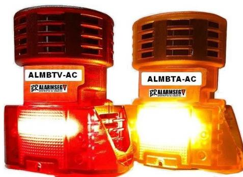
Com um sistema de refrigeração inovador, o indicador sonoro e visual ALMBT-AC utiliza o próprio fluxo de ar gerado para produzir o som e resfriar o motor simultaneamente, garantindo operação contínua sem risco de superaquecimento. Destaque-se ainda mais com sua iluminação em LEDs de alto brilho, que proporciona excelente visibilidade em qualquer condição, seja durante o dia ou à noite.
