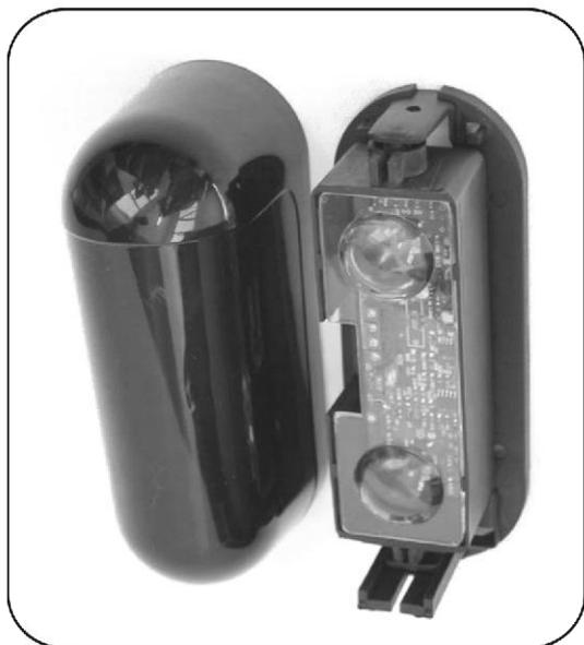
Os Sensores Ativos de Feixe Duplo são sistemas de detecção de intrusão pelo corte de um feixe alinhado de luz infravermelha. Somente com o corte dos dois feixes simultaneamente é que o sensor sinaliza a intrusão.
